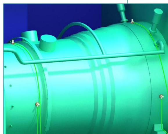
4 датчика виброперемещения и 1 датчик осевого сдвига
